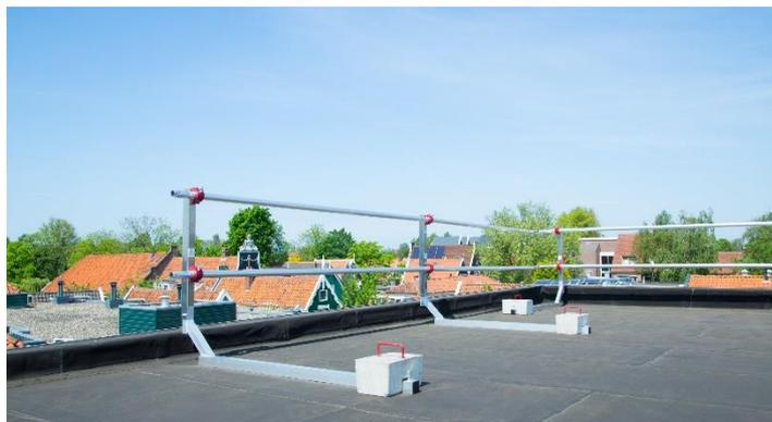
5.1.3: Wenn Sie 2 Grundrahmen aufgestellt haben, klappen Sie den Ständer in die senkrechte Position und stellen Sie sicher, dass er verriegelt ist. Bewegen Sie dazu den roten Verriegelungshebel nach oben und wieder zurück, um sicheres einrasten gewährleisten.
